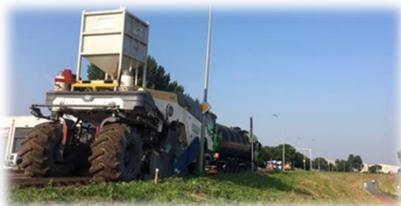
Mengen bitumen en cementslurry in een werkgang
